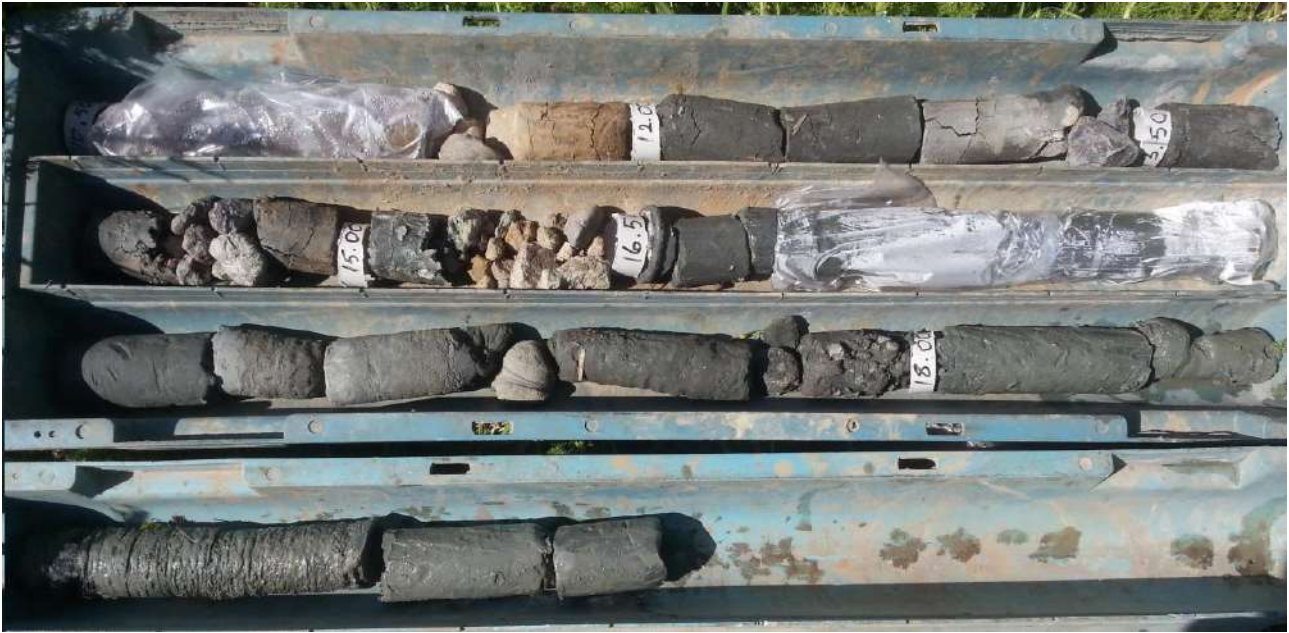
Şekil 9.3. : Çok katı – Sert Kil Tabakasından Alınmış Karot Örnekleri (SK-2)
