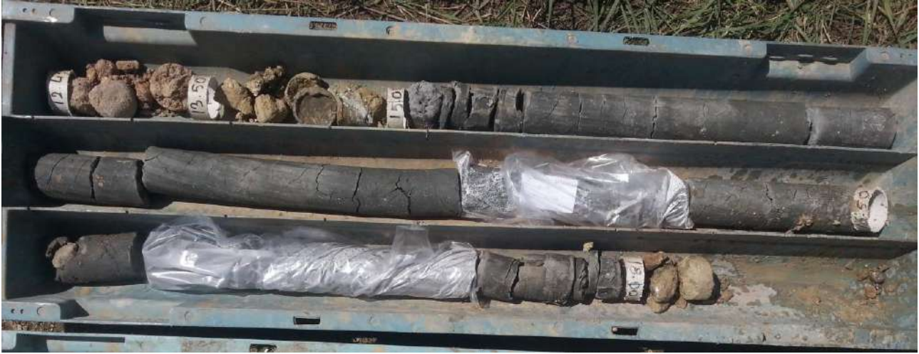
Şekil 9.2. : Çok katı – Sert Kil Tabakasından Alınmış Karot Örnekleri (SK-5)
